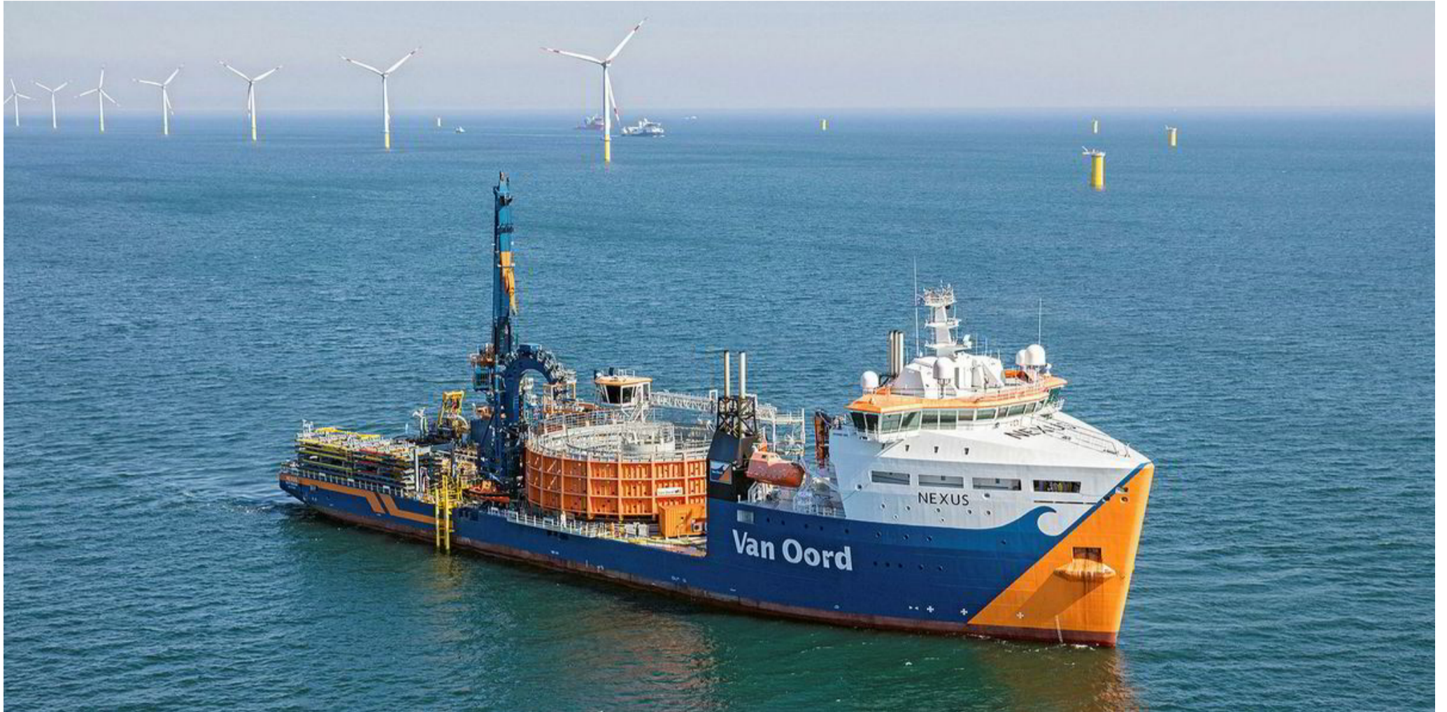
Van Oord cable laying vessel Nexus operating off Taiwan Photo: Van Oord
